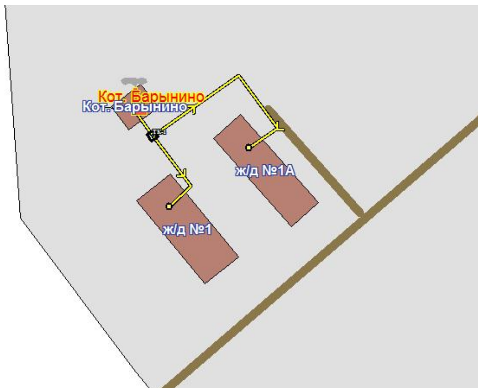
Рисунок 3.8 - Схема тепловой сети котельной д. Барынино, д. 62 сельского поселения Колубакинское
