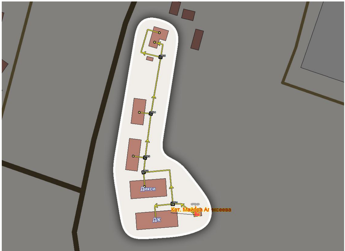
Рисунок 4.6 - Зона действия системы теплоснабжения котельной п. Колубакино, ул. Майора Алексева "клуб" сельского поселения Колубакинское
