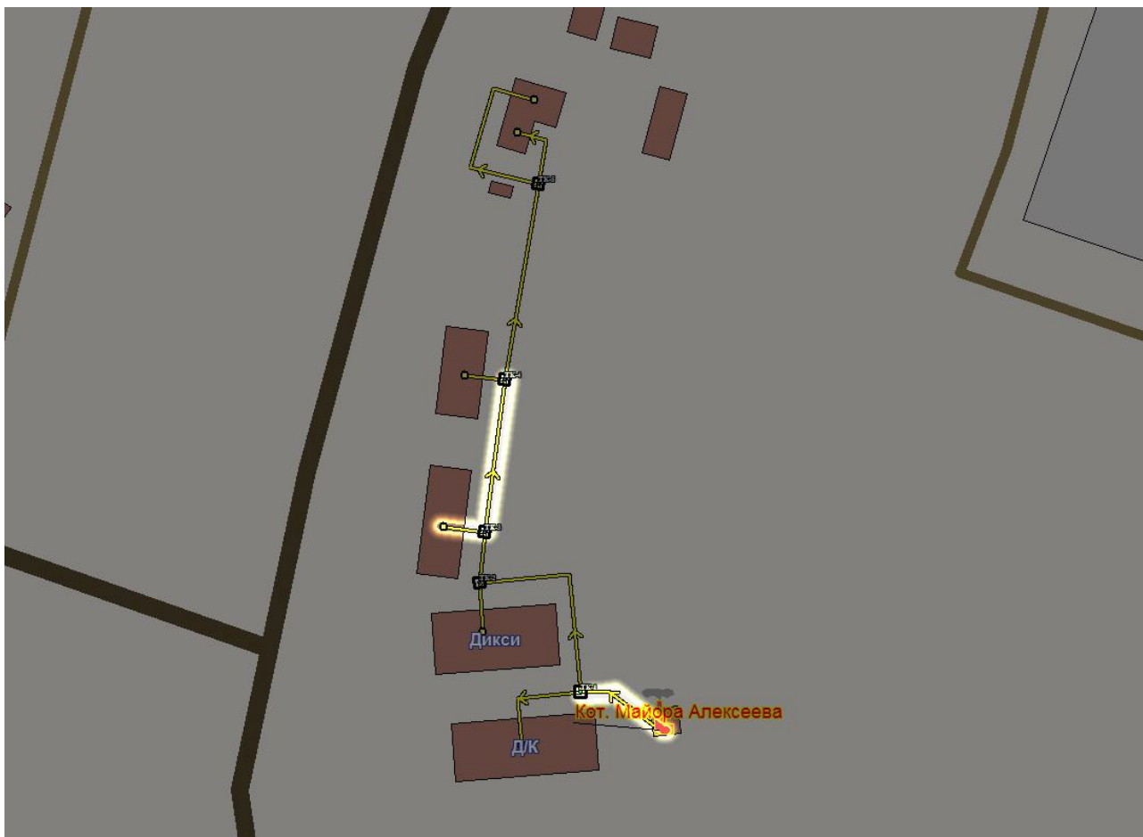
Рисунок 5.4 - Участки тепловой сети котельной п. Колюбакино, ул. Майора Алексеева "клуб" с завышенными удельными сопротивлениями
