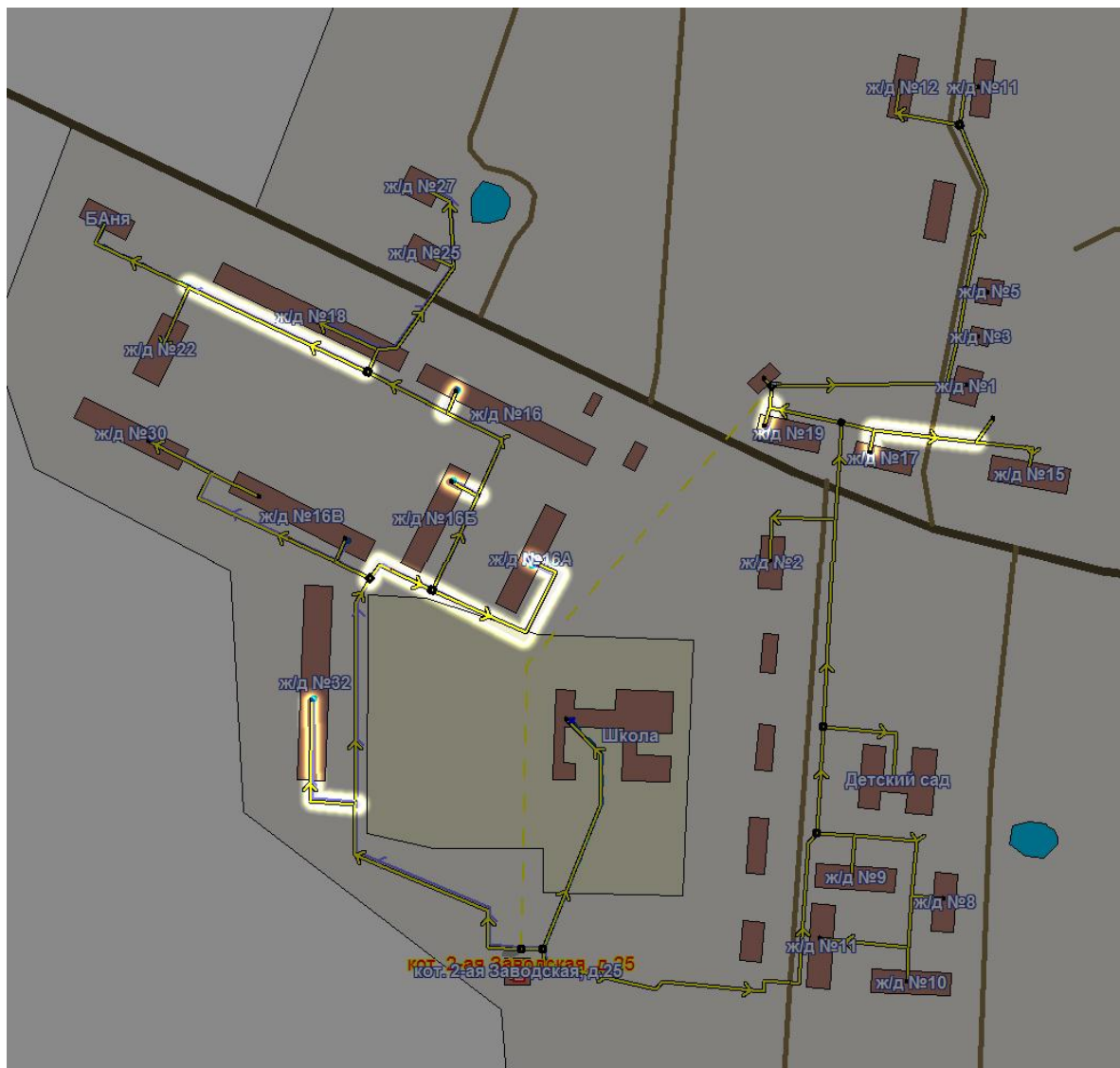
Рисунок 5.1 - Участки тепловой сети котельной п. Колюбакино, ул. 2-ая Заводская, д.25 с завышенными удельными сопротивлениями
