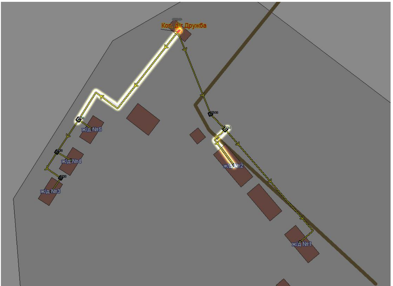
Рисунок 5.3 - Участки тепловой сети котельной п. Колюбакино, детский санаторий "Дружба" с завышенными удельными сопротивлениями
