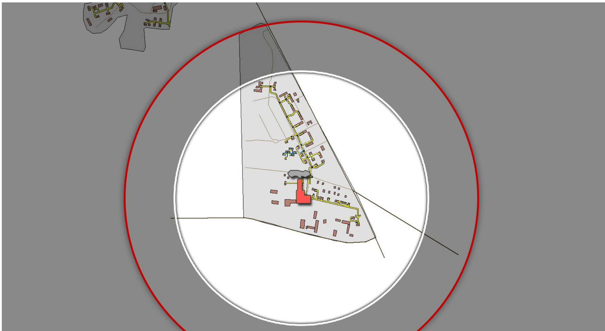
Рисунок 2.1 – Действительный и эффективный радиусы теплоснабжения котельной д. Нестерово сельского поселения Староружское
