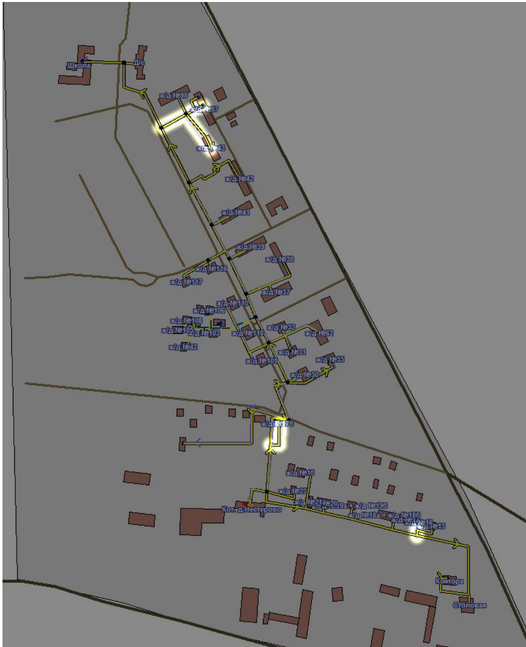
Рисунок 5.1 - Участки тепловой сети котельной д. Нестерово с завышенными удельными сопротивлениями
