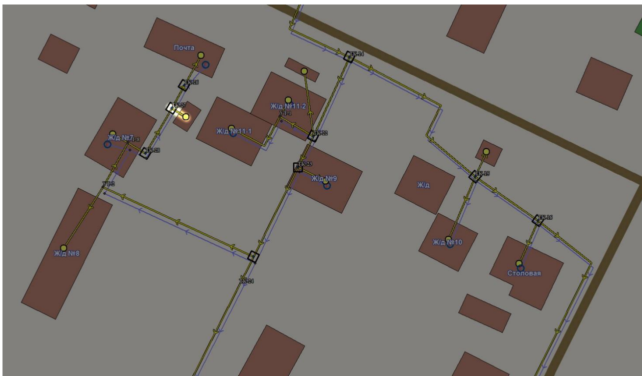
Рисунок 5.1 - Участки тепловой сети котельной д. Нововолково, д.22 с завышенными удельными сопротивлениями
