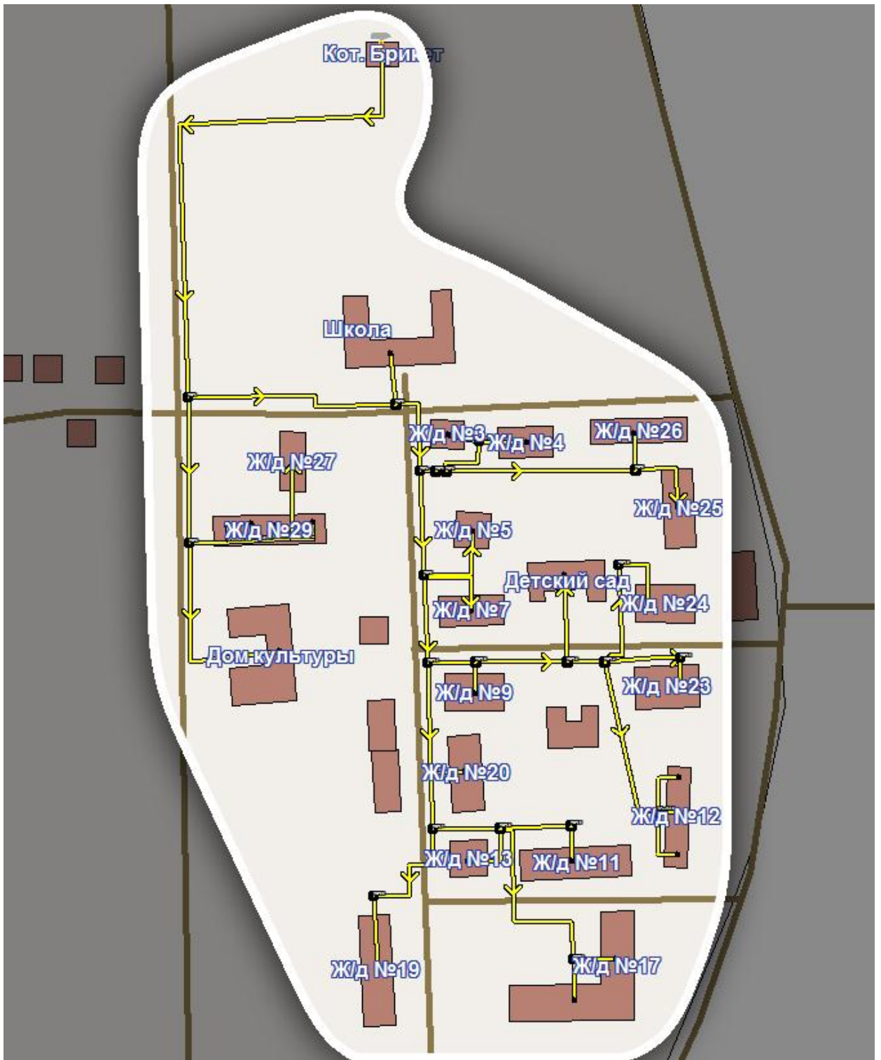
Рисунок 2.8 - Зона действия системы теплоснабжения котельной п. Брикет сельского поселения Волковское
