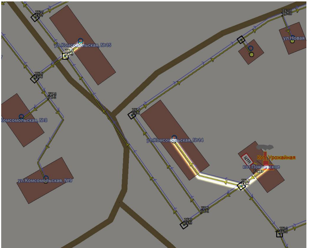
Рисунок 5.2 - Участки тепловой сети котельной с. Покровское, ЖКХ, ул. Урожайная, д.8 с завышенными удельными сопротивлениями
