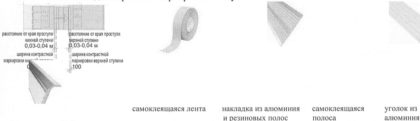
Рис. «Внешний вид контрастной маркировки на ступенях»
