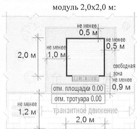
схемы места размещения нестационарного торгового объекта при размещении модуля палатки на Т-образном перекрестке тротуаров:
