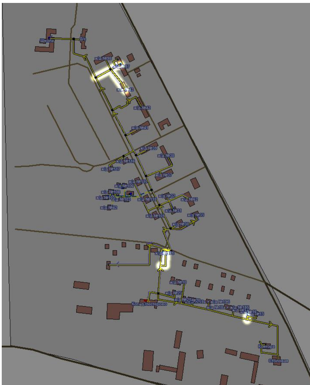
Рисунок 7.1 - Участки тепловой сети котельной д. Нестерово с завышенными удельными сопротивлениями
