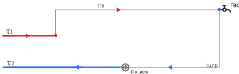
Рисунок 2.2.2.1.1 Схема подключения потребителей (нагрузка ГВС) по 4-х трубной схеме к тепловым сетям котельных Рузского городского округа Московской области.
