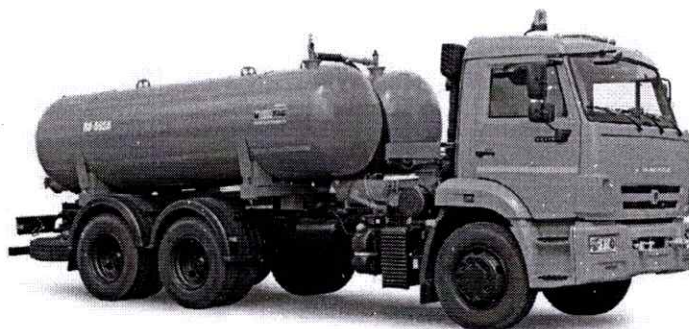
Рис. 5.1. Вакуумная машина КО-505А на шасси КамАЗ-65115-71
