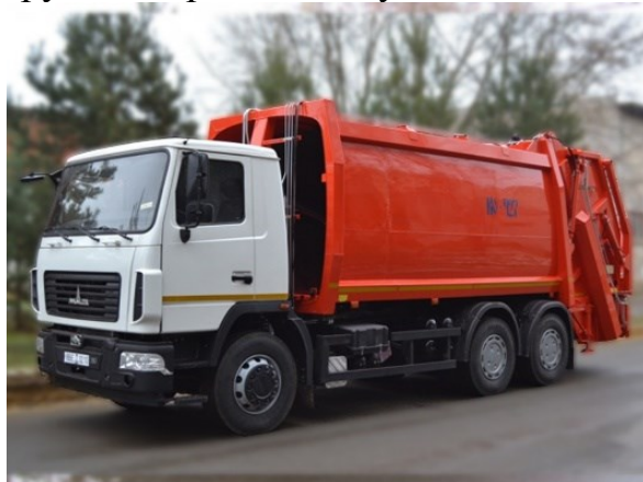
Рис. 4.14. Мусоровоз с задней загрузкой КО-427-90 на базе шасси МАЗ-6312С3
