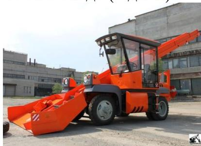
Рис. 6.20. Лаповый снегопогрузчик КО-206.
